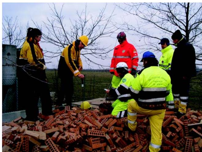
Nelle foto: alcuni operatori del gruppo Le Aquile, durante una prospezione di protezione civile con il rilevatore Geofono.
