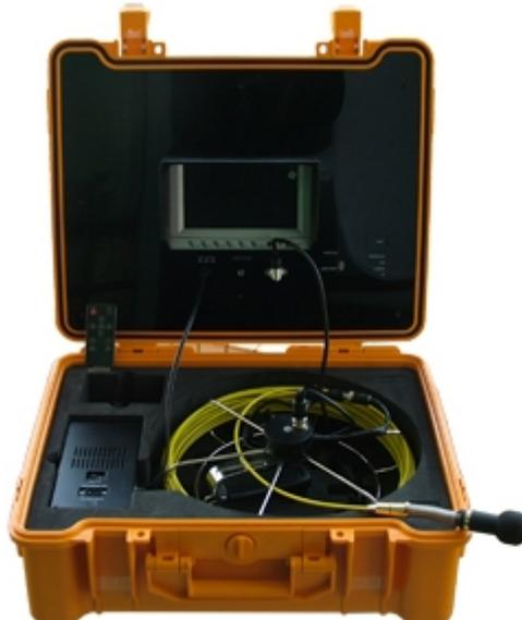
**Monitor LCD TFT a colori da 10" Cavo in fibra ottica da 20 mt.**
